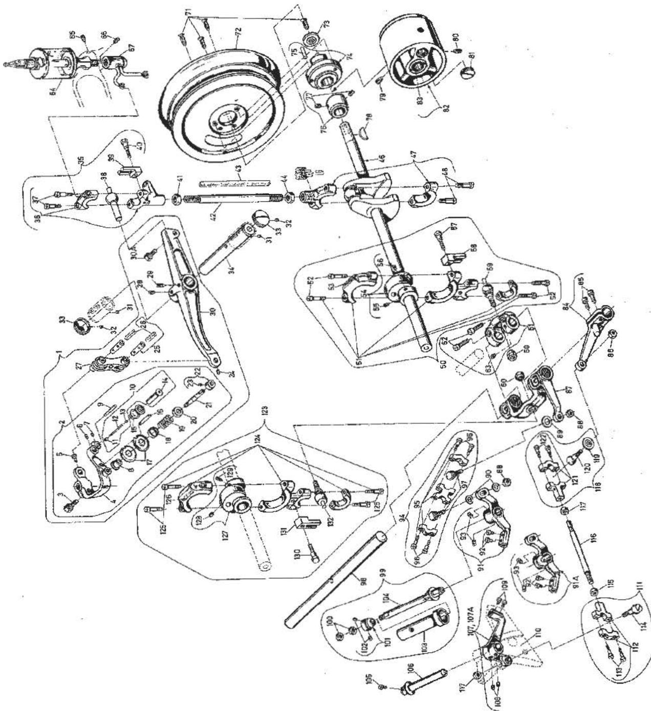
NEEDLE LEVER, PULLEY, CRANKSHAFT AND LOOPER DRIVE
