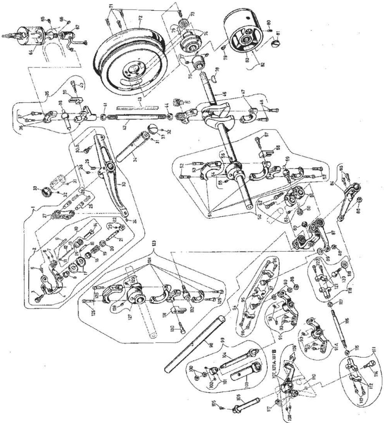
NEEDLE LEVER, PULLEY, CRANKSHAFT AND LOOPER DRIVE
